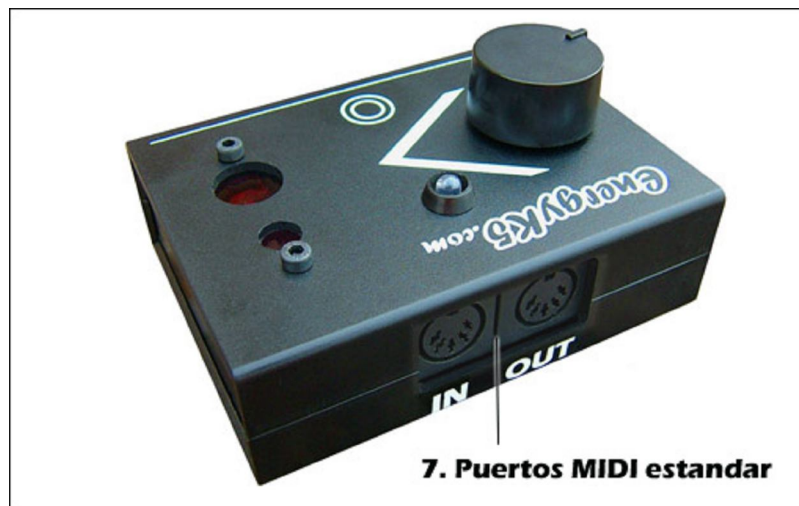
Figura 2. Detalle de los conectores MIDI.
